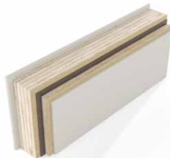
BLINDADO 21,6 PVC MADERA 17 + 4 MM BLINDAJE ACERO 0,6 MM
