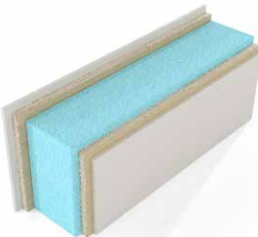
MIXTO 38 MM MADERA 4 + 4 MM POLIESTIRENO 30 MM
