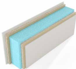
MIXTO 29 MM MADERA 4 + 4 MM POLIESTIRENO 21 MM
